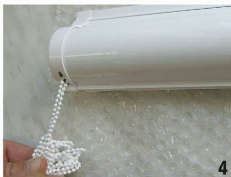
Abb. 6: Kassette vorsich- tig andrücken und waagrecht ausrichten.
